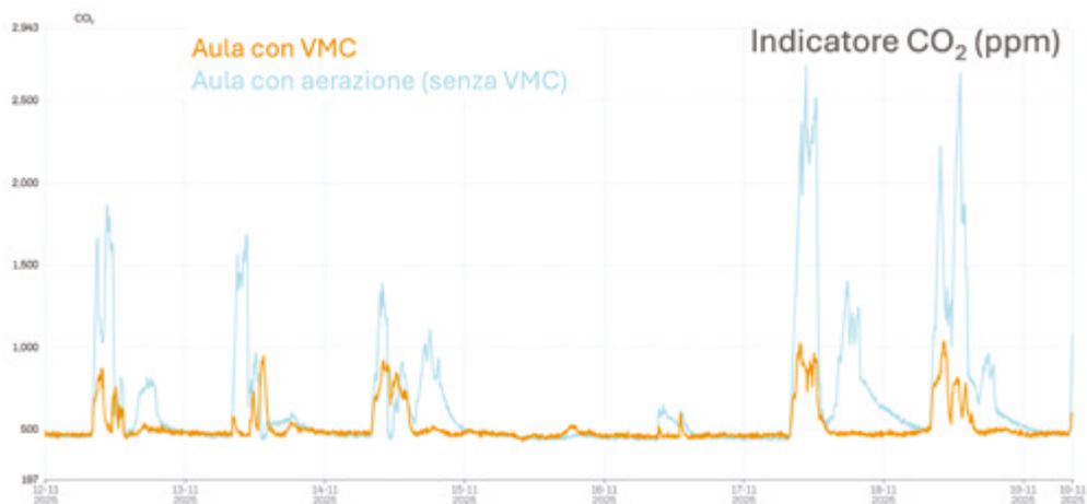
Figura 16. CO 2 in aula con e senza VMC. Istituto tecnico
